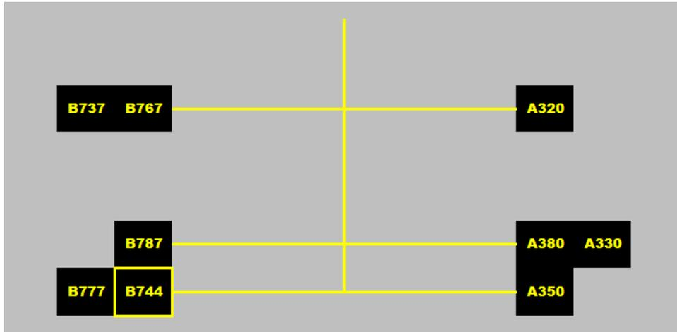
圖 1 停機位停止線機型標示示意圖
