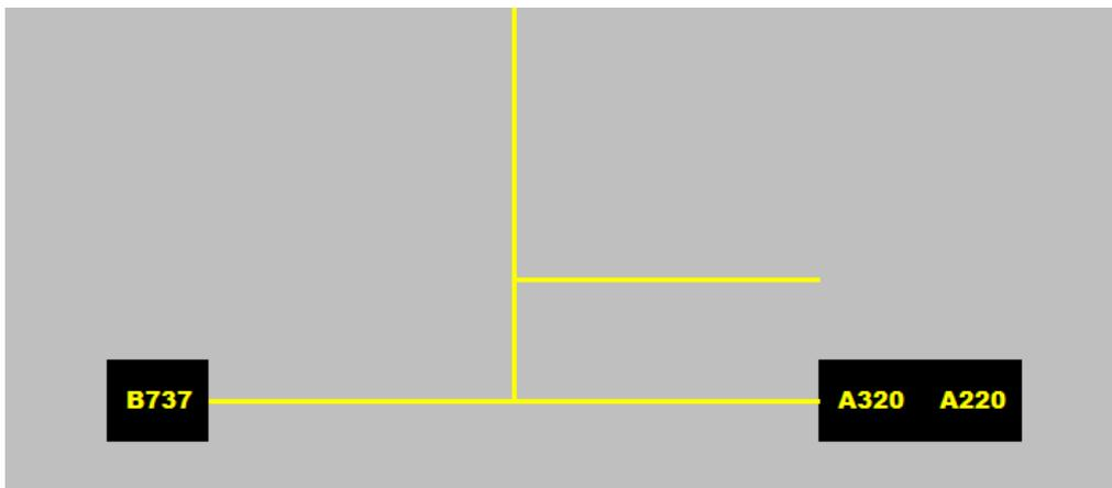
圖 2 接駁坪 610 停機位停止線機型標示示意圖
