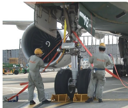
鎖機樁固定作業
