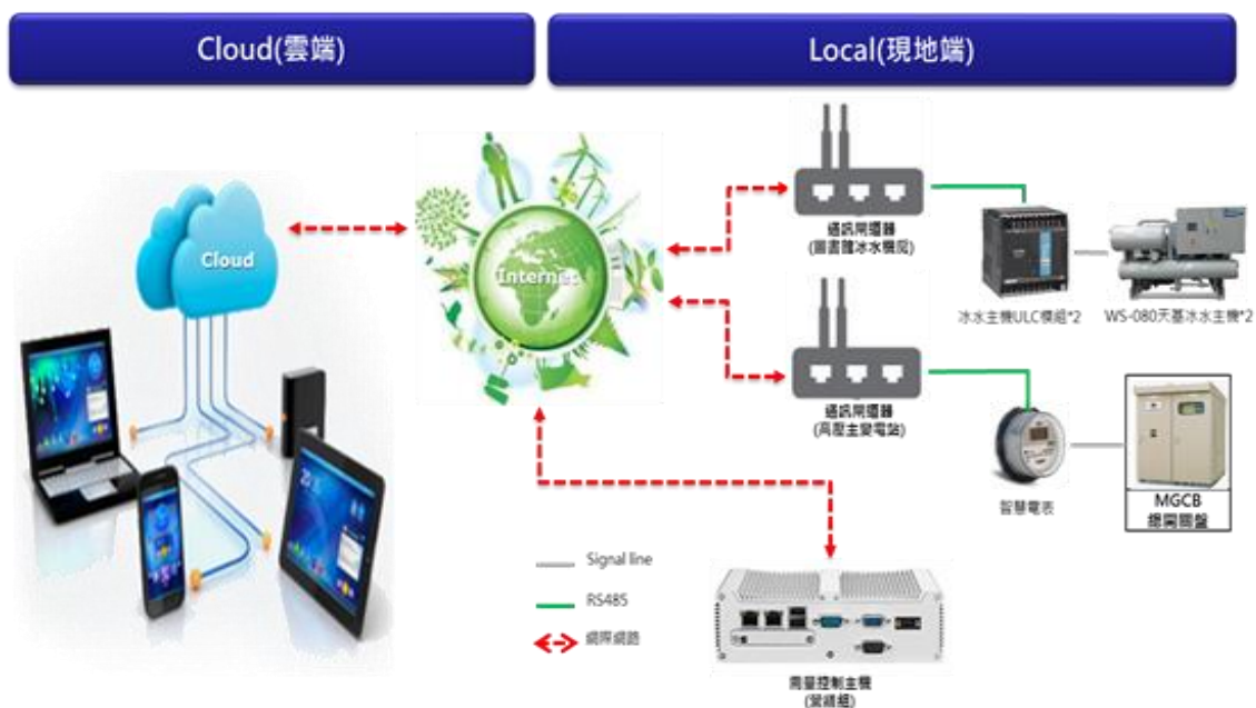
圖 60 機場公司智慧能源管理系統應用示意圖
