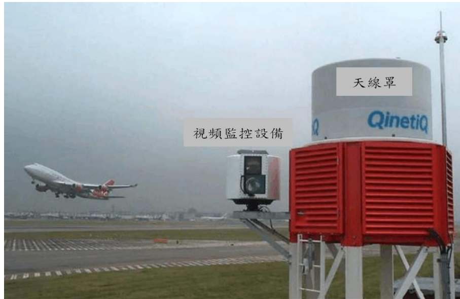
圖 75 Tarsier1100(T1100) FOD 系統
