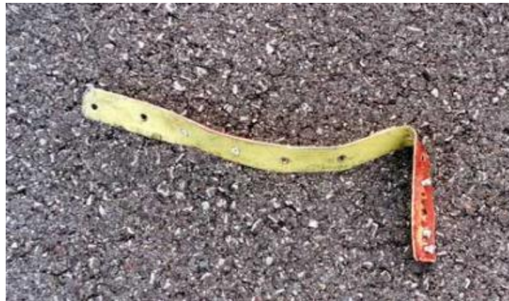
圖 73 協和飛機肇因之金屬片照片
