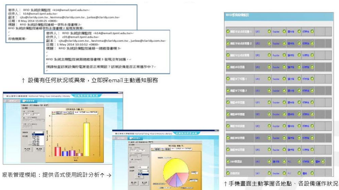
圖 66 設備維護雲端監控管理系統示意圖
